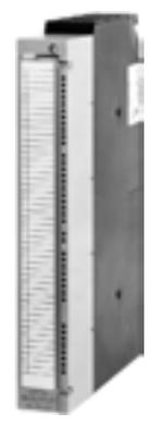
Las tarjetas de entrada/salida digitales son una combinación de entrada y salida digital en la misma tarjeta. En la parte de entrada digital convierten las señales binarias externas del proceso al nivel interno del autómat. En la parte de salida digital con-
