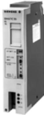
La fuente de alimentación PS 951 genera la tensión de servicio de DC 5 V para el autómata a partir de la tensión de red externa de DC 24 V. Para el autómata de seguridad S5-115F sólo está permitida la fuente PS 951-7ND41.
