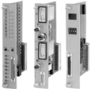
Las tarjetas de simulación reproducen las señales de entrada y salida, permitiendo así el control de las correspondientes tarjetas.
