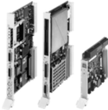
El CP 581 es un PC compatible AT utilizable en los autómatas S5-115U, S5-135U y S5-155U/H. Ofrece una potencia de cálculo suplementaria en combinación con la unidad central del autómata para resolver tareas complejas de automatización.
