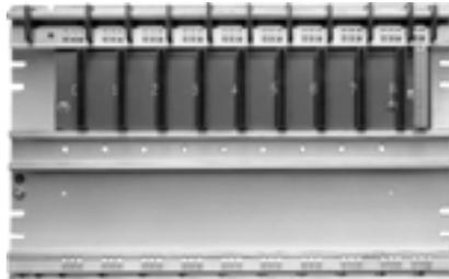
Con el bastidor ER 701-1 se puede formar un aparato de ampliación con 9 tarjetas periféricas, como máximo. La alimentación de corriente se realiza desde el aparato central o desde un aparato de ampliación con los bastidores ER 701-2 o ER 701-3.
