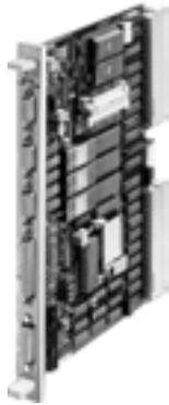
La tarjeta de posicionamiento IP 247 permite posicionar 3 ejes independientes con motores paso a paso.
