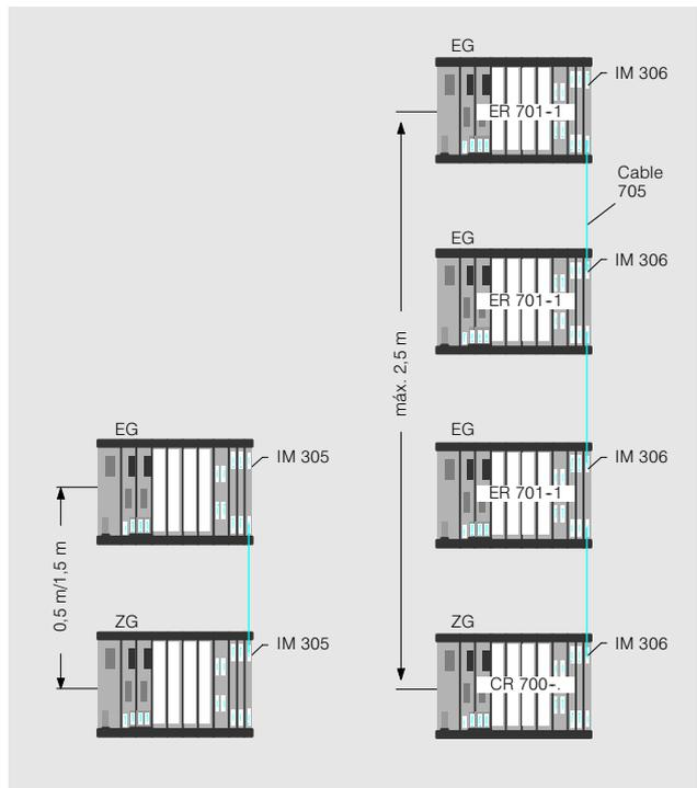
Fig. 3/33 Conexión centralizada de aparatos de ampliación a uno central por medio de las interfases IM 305 (izquierda) e IM 306 (derecha)
