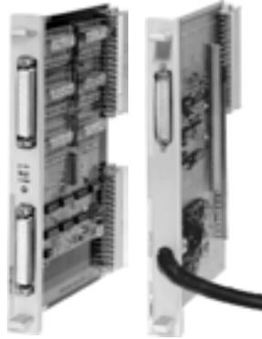
Las interfases IM 300/ IM 312 son adecuadas para la conexión centralizada de tarjetas periféricas y preprocesadoras de señal (sin direccionamiento de página) a un aparato central a través de los siguientes aparatos de ampliación:
